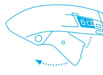
Gire la palanca hacia fuera del mango y abra la cubierta de la hoja.
