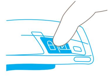
Para evitar la activación no intencionada de la hoja, bloquee siempre el cúter presionando hacia abajo el símbolo de bloqueo.
