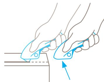
La hoja se retrae automáticamente dentro del mango al finalizar el corte. Incluso cuando la palanca está aún siendo presionada.
