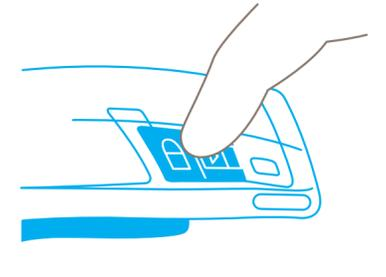
Para evitar la activación no intencionada de la hoja, bloquee siempre el cúter presionando hacia abajo el símbolo de bloqueo.
