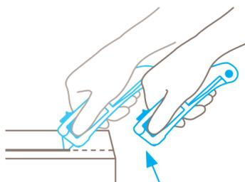
La hoja se retrae automáticamente dentro del mango al finalizar el corte. Incluso cuando el desplazador esté aún **presionado hacia adelante**.
