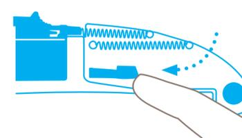
Libere el cargador de la hoja **presionando hacia abajo y empujando hacia delante**, como se indica.
