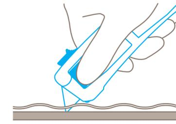
Cuando corte láminas de aluminio, asegúrese de ejercer **suficiente contra presión** para que la hoja no se retraiga por sí misma.
