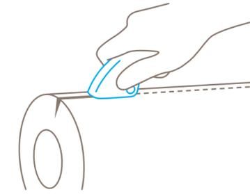
Use la parte inferior del cabezal de la hoja como superficie de apoyo para trabajar ergonómicamente y eficientemente.
