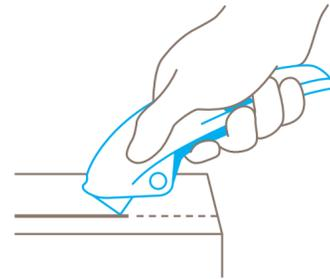
Para poner la hoja a punto para cortar, desbloquee el cúter y presione la palanca. Ahora puede cortar.
