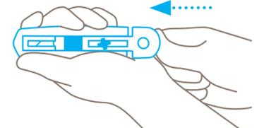
Placer la lame **exactement sur les ergots**, relever le support de lame. Réintroduire l'insert plastique dans le manche. **ATTENTION** : Ne pas placer la main dans la zone de sortie de la lame !
