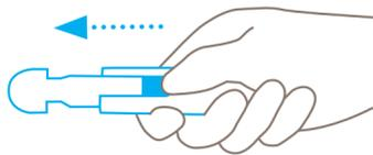
En prenant appui sur le curseur, **pousser** l'insert en plastique hors du manche. **Ne pas** simultanément tirer sur l'insert et maintenir le curseur.
