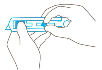
Pour modifier le débord de lame, **desserrer la vis de blocage** (d'un tour). Plus la vis se situe à gauche, plus le débord est grand.
