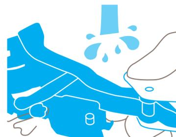
¡**Antes** de limpiar, sacar la hoja! En función del tipo de suciedad limpiar con aire comprimido, agua, alcohol o acetona.
