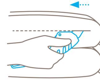
... e **insertarla** en el material (por ejemplo, saco). **Atención:** no cortar nunca en dirección al propio cuerpo. Tras cortar **soltar** la palanca, la hoja se retrae.
