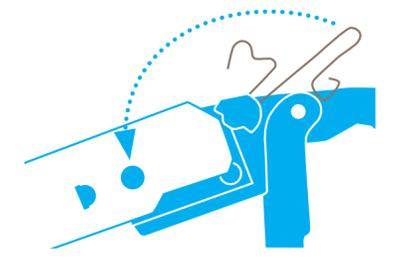
**Bloquear el muelle** y girar de nuevo la **palanca** hacia el mango hasta que **engarce** automáticamente. Desbloquear la palanca y pulse una vez para probar.
