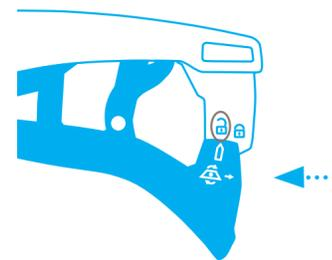
Para cortar solo hay que **desenclavar** el activador de seguridad.
