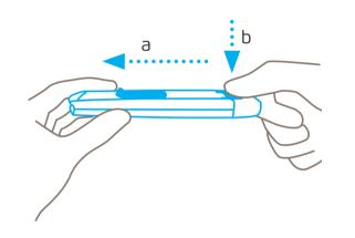
Cierre la cubierta de la hoja y coloque de nuevo el inserto de plástico en el mango. Finalmente, **presione hacia abajo** el pulsador para cambio de hoja.
