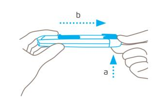
Presione el pulsador para cambio de hoja **de abajo arriba** y tire del inserto de plástico hacia para abrir la cubierta de la hoja. La cubierta atrás con el mango.
