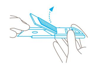
Coger la cuchilla por el lado **romo** y utilizarla para abrir la cubierta de la hoja. La cubierta se queda en posición abierta.
