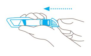
Cerrar la cubierta de la hoja e insertar la pieza de plástico de nuevo en el mango hasta que se **oiga** que el botón de cambio de hoja encaje.
