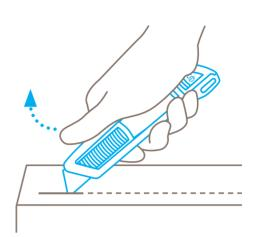
Retire su **pulgar del desplazador** para asegurar la retracción automática de la hoja.
