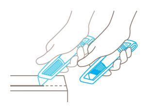
Al final del corte, la hoja se retrae inmediatamente dentro del mango. Condición: Ud. debe **soltar** el desplazador.
