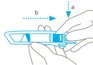
**Pulse** el botón de cambio de hoja y saque la pieza de plástico del mango desplazándola hacia atrás.
