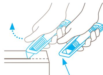
Al final del corte, la hoja se retrae inmediatamente dentro del mango. Condición: Ud. debe **soltar** el desplazador.
