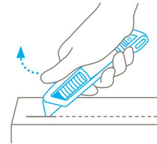
Retire su **pulgar del desplazador** para asegurar la retracción automática de la hoja.
