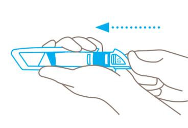
Cerrar la cubierta de la hoja e insertar la pieza de plástico de nuevo en el mango hasta que se **oiga** que el botón de cambio de hoja encaja.
