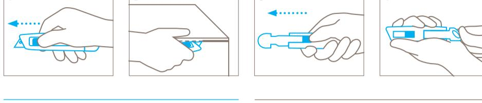
**D) Verwendung:** Sicherheitsmesser für alle normalen Schneidarbeiten, insbesondere Kartonöffnen. TÜV-geprüft.
