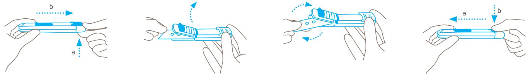
**Appuyez** sur le bouton de changement de lame et tirez l'insert en plastique vers l'arrière pour le sortir du manche.
