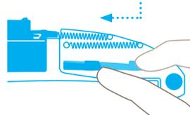
Décrochez le support de lame dans le sens de la flèche et faites-le coulisser **lentement vers l'avant**.
