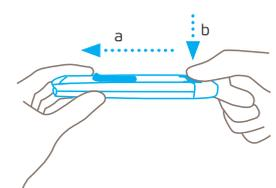
Refermez la protection de la lame et repoussez l'insert en plastique dans le manche jusqu'à ce que le bouton de changement de lame reprenne sa position initiale.
