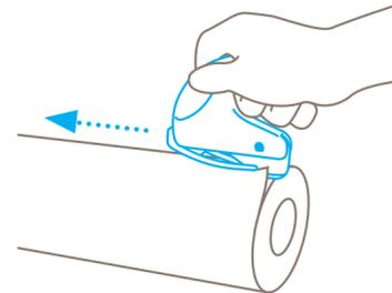
Pour les bandes de films et de papier, **percer** à l'endroit souhaité avec la pointe du pied métallique.
