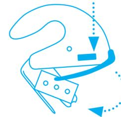
Appuyer sur la languette et, **simultanément**, extraire le pied métallique de la poignée. Re-tourner ou changer la lame.
