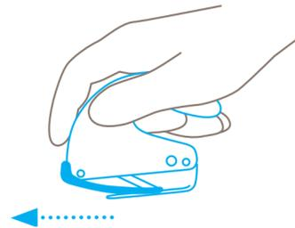
**Principe de base :** découper d'un mouvement régulier en direction de l'avant en exerçant une légère **pression**.
