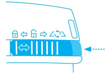
Con el seguro 3 en 1 usted puede **bloquear** la herramienta después del corte.
