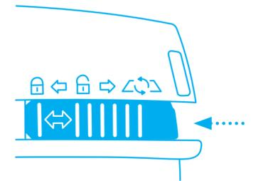
Por último vuelva a empujar la palanca **dentro del mango** y ajuste el seguro 3 en 1 en la posición de bloquear o desbloquear.
