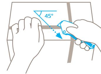
Los flejes de plástico se deben cortar **preferentemente en forma diagonal** (en ángulo de 45°).
