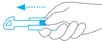
Use el desplazador de la hoja para **empujar** el inserto de plástico hacia atrás y afuera del mango. No estire el inserto mientras esté presionando el desplazador de la hoja.
