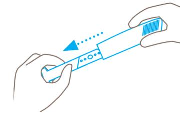
Sacar la parte interior en la dirección indicada por la flecha. Asegurar la hoja con el dedo pulgar. Asegúrese de que coloca la nueva hoja o la que ha girado, **exactamente** sobre los pivotes.
