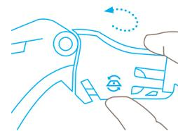
Finalmente, **cierre** la cubierta de la hoja y **vuelva** a colocar el soporte para las hojas en el mango. **Escuchará** un ruido cuando el botón del cambio de hoja se encaje.
