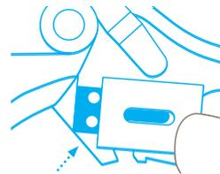
Danach die Klinge links **an der Kante ausrichten** und **exakt** auf den Nocken zurücklegen.
