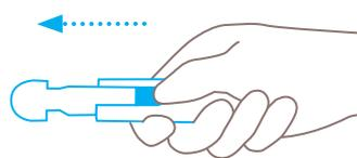
Drücken Sie den Kunststoffeinsatz mithilfe des Schiebers nach hinten heraus. Nicht am Einsatz ziehen und gleichzeitig den Schieber festhalten.
