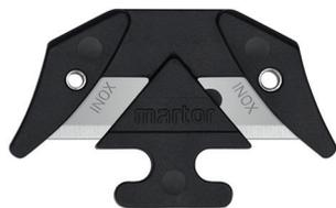
Die SECUMAX-KLINGE NR. 13448 von MARTOR ist ein hochwertiger und besonders robuster Klingenkopf aus rostfreiem Stahl und Kunststoff. Sie ist sehr scharf und verfügt über zwei nacheinander nutzbare Schneidkanten für eine höhere Einsatzzeit. Die Klinge ist 38,9 mm lang, 23,7 mm breit und 0,50 mm stark.
